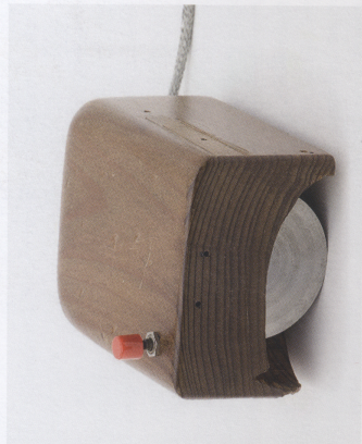
Nachbau einer Engelbart-Computermaus Doug Engelbart entwarf 1963 den Prototyp einer Computermaus, die mit scharfkantigen Rädern und einem Druckknopf ausgestattet war
